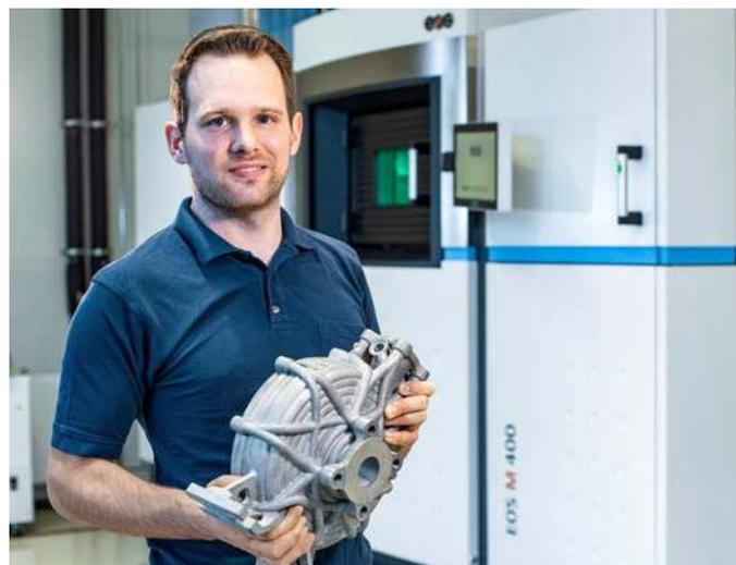
Прогрессивные технологии аддитивного производства позволяют изготавливать комплексные конструктивные элементы.
